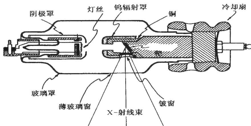
图 9-1 X 射线管结构及原理
