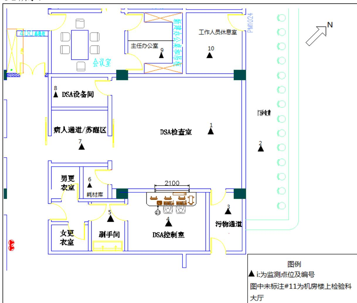
**图 8-1 拟建 DSA 机房平面布置及监测布点图**
